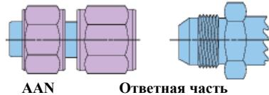
**Примечание:** Концевая втулка изготавливается с предварительно установленными обжимными кольцами Gyulok фирмы "Хоук". При монтаже следовать инструкциям по переборке на странице 53.
