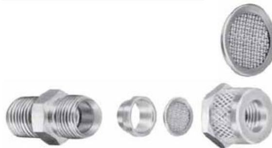
Для полиэтиленовых труб применяется арматура Gyrolok фирмы «Хоук» с гайкой с накаткой и нейлоновым уплотнительным кольцом. Затяжка вручную позволяет быстро монтировать и демонтировать трубы, обеспечивая надежное уплотнение, что идеально подходит для лабораторных условий. Такую арматуру можно применять как для стеклянных трубок, так и для других труб со стенками из прочных материалов.
