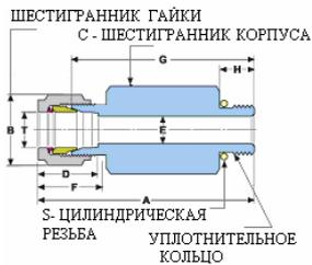
**Удлиненный переходной штуцер с наружной резьбой SAE: LCMS**
