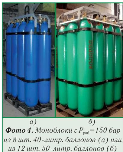
**Фото 4.** Моноблоки с  $P_{\text{раб}} = 150$  бар из 8 шт. 40-литр. баллонов (а) или из 12 шт. 50-литр. баллонов (б)
